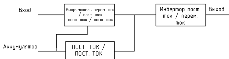
Рисунок 2-2. Схема модуля питания
