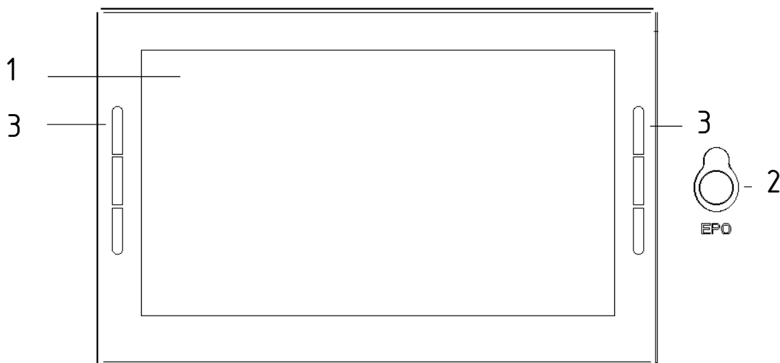
1: Сенсорный экран ЖК-дисплея. 2: Переключатель EPO. 3: Индикатор состояния Рисунок 4-1. Панель управления и отображения ИБП
