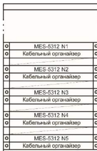
Рисунок 24 – Размещение коммутаторов MES5312 в стойке
