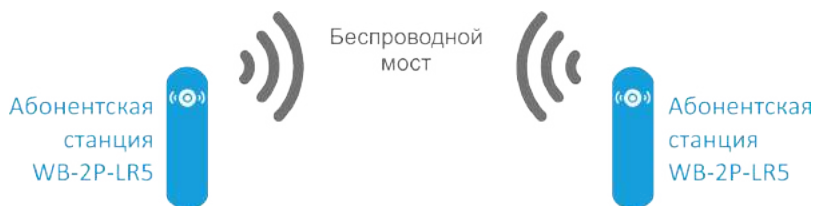
Функциональная схема использования WB-2P-LR5 для организации беспроводного моста
