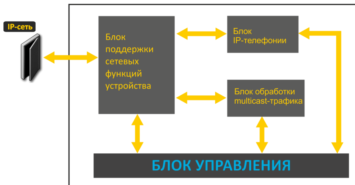
Рисунок 3 — Функциональная схема устройства серии TAU-2M.IP
