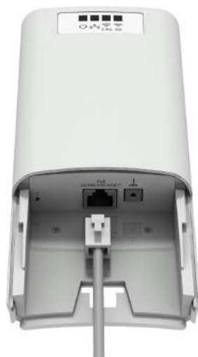
Рисунок 14 – Подключение Ethernet-кабеля к PoE-порту
