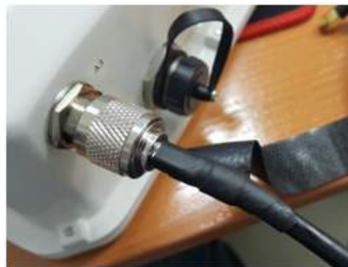
Герметизация разъема N-типа
