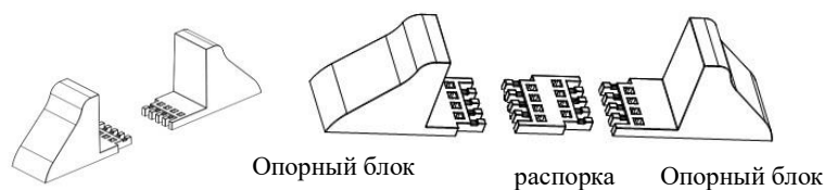
Рис. 3-1 Опорные блоки и распорки
