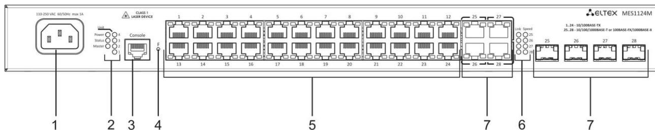
Рисунок 7 — MES1124M AC, передняя панель
