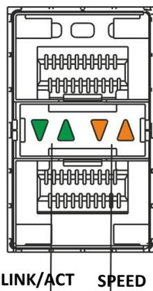
Рисунок 20 — Внешний вид разъема с SFP-трансиверами
