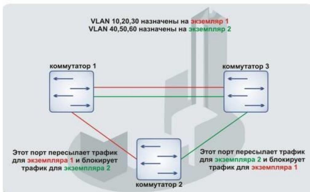
Рисунок 31— Настройка протокола множества связующих деревьев
