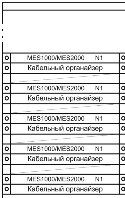
Рисунок 23 — Размещение коммутаторов в стойке
