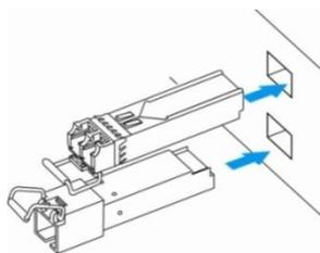
Рисунок 25 — Установка SFP-трансиверов
