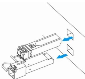
Рисунок 28 — Извлечение SFP-трансиверов
