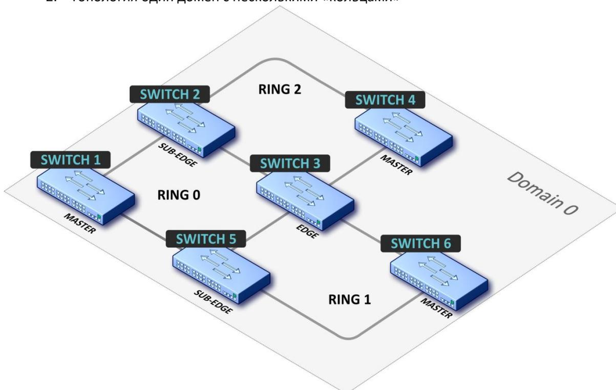
В топологии сети 3 кольца (может быть 2 и более) и 2 общих узла между ними. В этом случае необходимо определить EAPS-domain и установить одно кольцо в качестве основного, а другие как вторичные.
