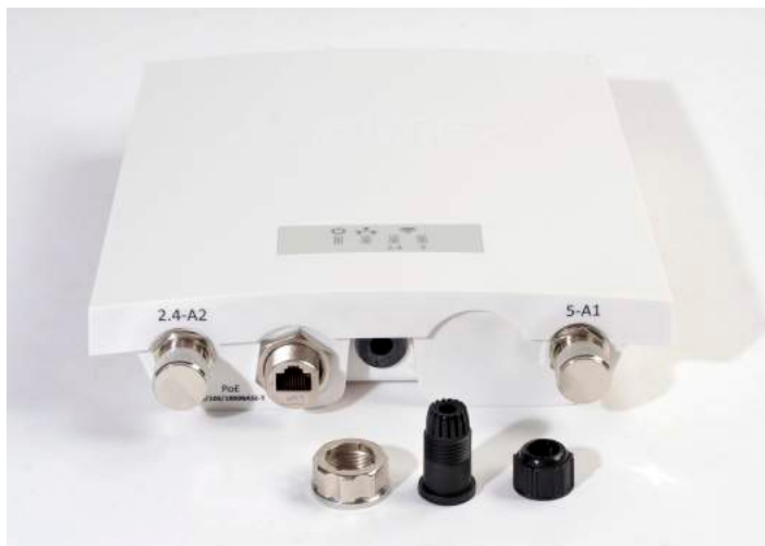
Рисунок 14 – Герметичный разъем RJ-45 на устройстве и ответная часть в разобранном виде для аппаратных версий 1v0, 1v1 и 1v2
