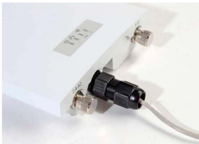
Рисунок 24 – Вид подключенного кабеля к сетевому интерфейсу устройства
