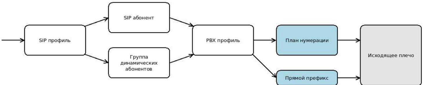
Входящий вызов поступает на SIP-профиль. Если в настройках SIP-профиля указан входящий профиль RADIUS, то на сервер RADIUS, связанный с выбранным профилем, будет отправлен запрос о возможности совершения вызова. Если сервер RADIUS откажет в соединении, то вызов на этом завершится.
