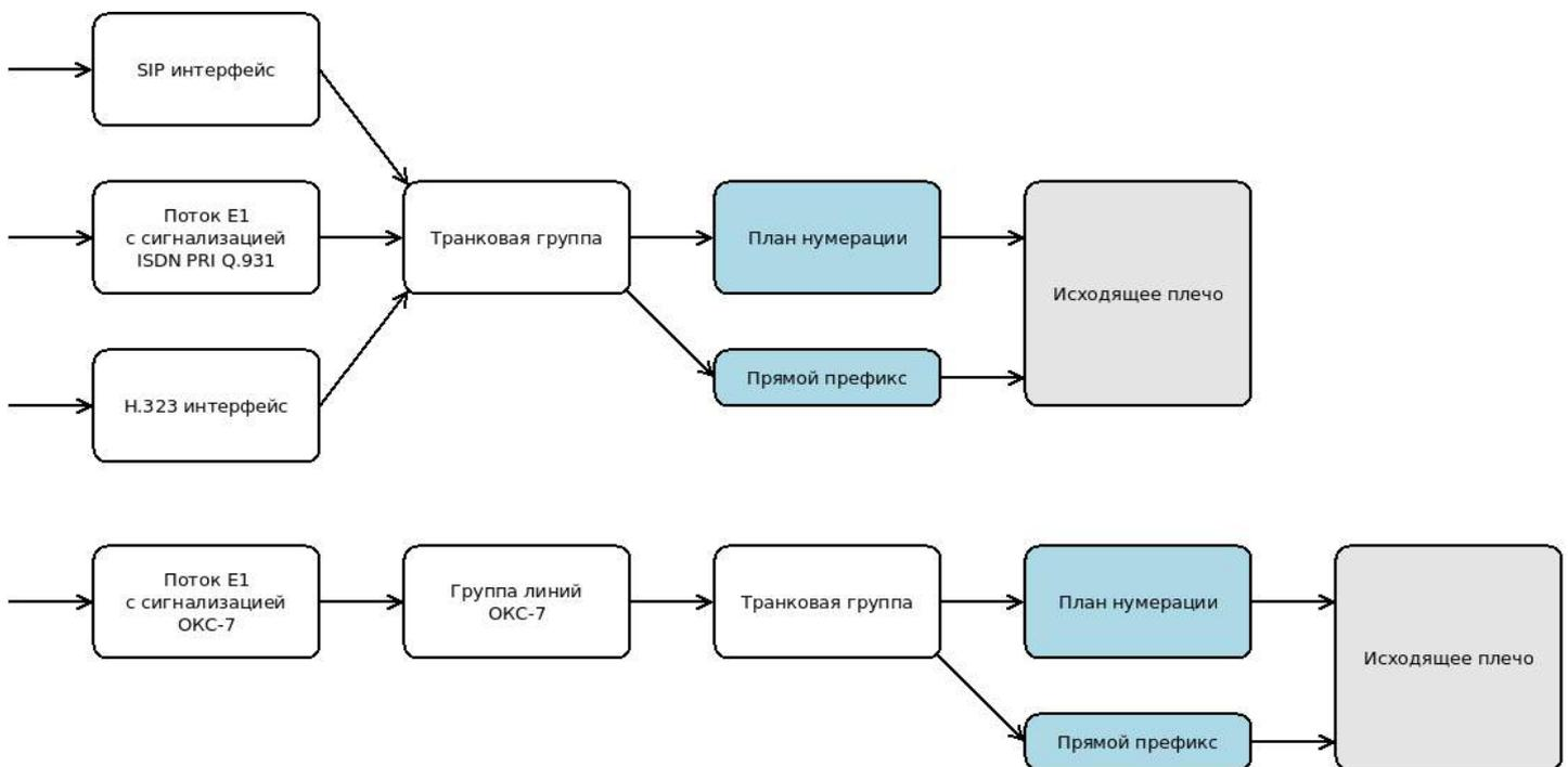
Входящий вызов поступает на интерфейс – поток E1 с сигнализацией Q.931, поток E1 с сигнализацией ОКС-7 (группу линий ОКС-7), интерфейс SIP или H.323. Также транковым может считаться вызов на порт FXO при условии, что существует транковая группа с привязанными к ней линиями FXO. Особенности вызова на FXO описаны в разделе [Обработка вызова в порт FXO](#).
