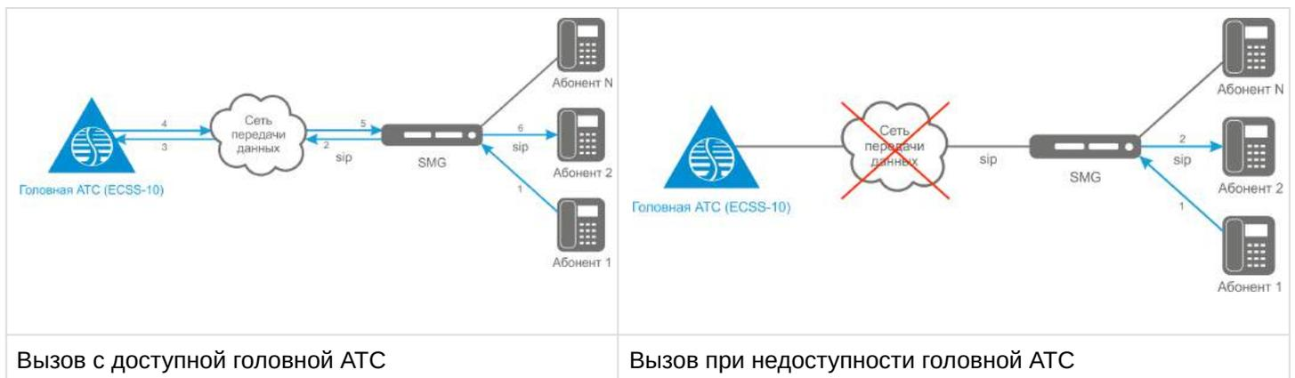
Потребуется создать на SMG транковый SIP-интерфейс в сторону головной АТС и настроить интерфейс для регистрации абонентов таким образом, чтобы он использовал SIP-транк в сторону ECSS-10 в качестве интерфейса urreg-регистрации.
