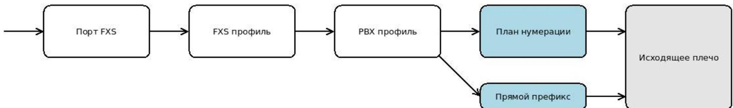
Вызов поступает на порт FXS, производится обработка настроек из привязанного к порту FXS-профиля и затем секции "Входящая связь" из привязанного к порту PBX-профиля. Важными настройками FXS- и PBX-профиля, влияющими на прохождение вызова, будут следующие:
