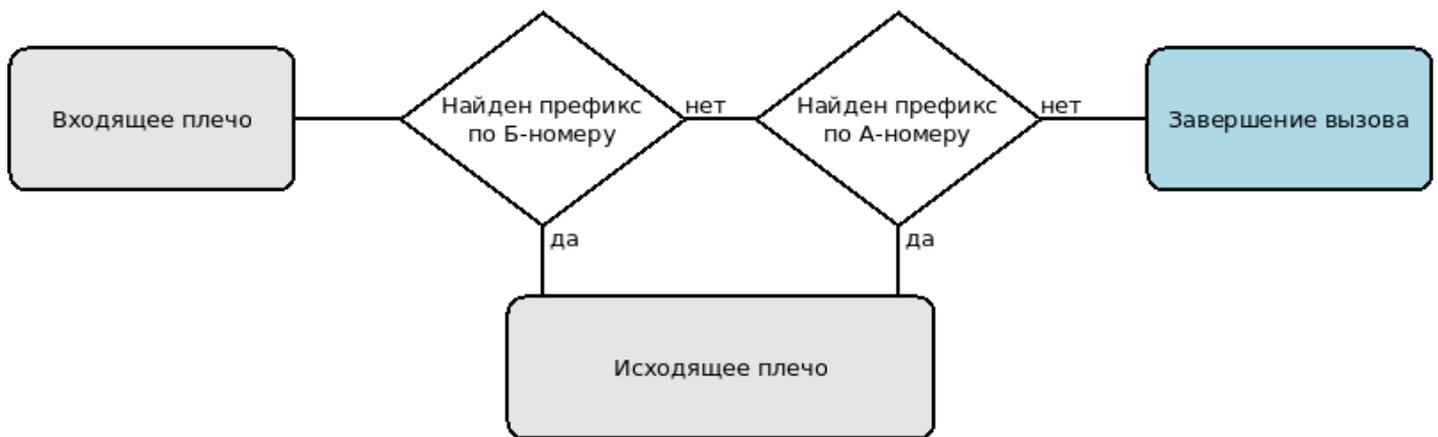
В плане нумерации производится проверка поступивших А- и Б-номеров с целью дальнейшей маршрутизации вызова. Обратите внимание, что если на входящем плече к номеру А или Б применялись модификации, то поиск производится по тем номерам, которые получились в результате. Модификации номера на исходящем плече вызова не влияют на результат маршрутизации и служат для смены номеров, отдаваемых SMG на взаимодействующее устройство.
