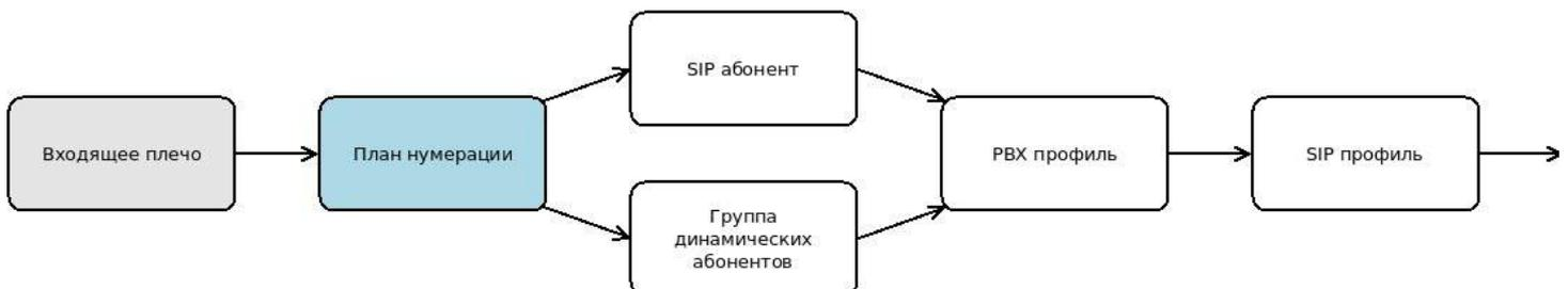
Вызов маршрутизируется на SIP-абонента или динамического абонента. В настройках абонента привязан PBX-профиль, где обрабатываются параметры исходящей связи. Основными параметрами, влияющими на последующее прохождение вызова, являются:
