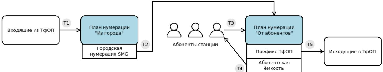
**Схема работы:** Вызов из города (T1) попадает в план нумерации 0, где настроен префикс с проверкой CdPN по городскому Б-номеру (73831234567). Этот префикс направляет вызов в план нумерации 1 (T2) и заодно меняет Б-номер на один из внутренних номеров, куда должны приходить все городские вызовы. В плане нумерации 1 вызовы маршрутизируются на абонента станции (T4). Вызовы с номером Б, отличным от внешнего городского, будут отбиты, т.к. для них не существует маршрута.
