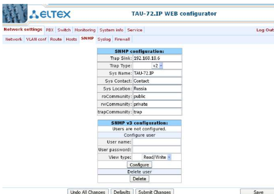
Рисунок 2.3 – Настройка протокола SNMP
