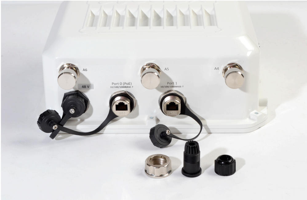
Рисунок 9 – Герметичный разъем RJ-45 на устройстве и ответная часть в разобранном виде
