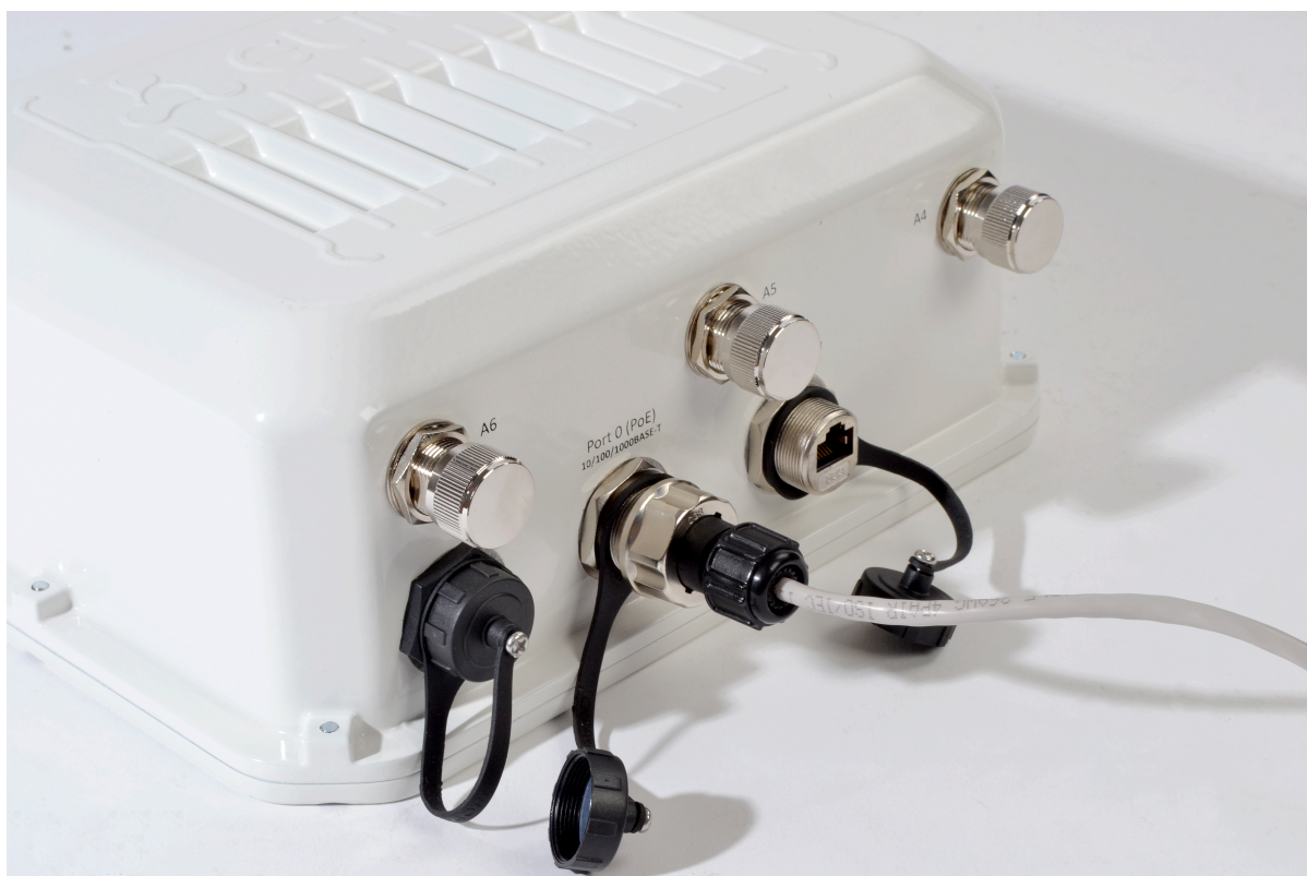
Рисунок 14 – Вид подключенного кабеля к сетевому интерфейсу устройства
