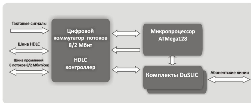
Рисунок 6 – Функциональная схема модуля 24АК (24АК-Д)
