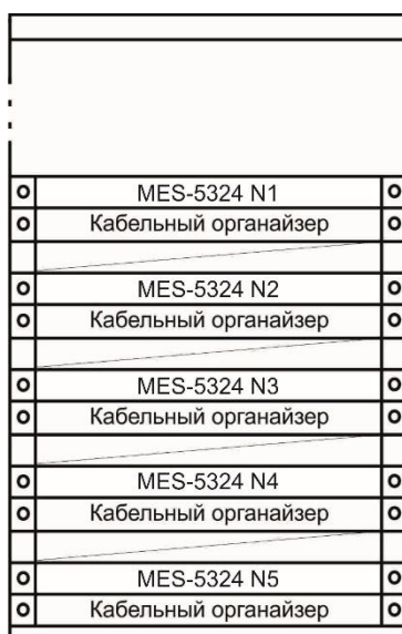
Рисунок 46 — Размещение коммутаторов MES5324 в стойке
