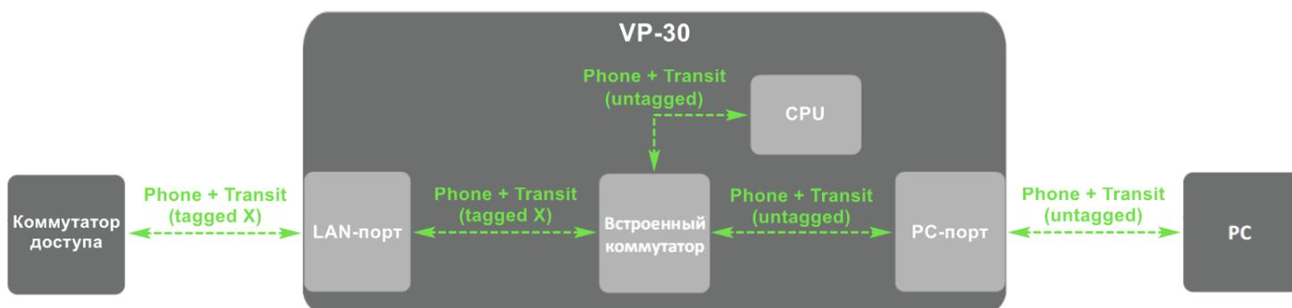
В данном случае сеть настроена по протоколу DHCP или Static с включенным VLAN для Phone-трафика и транзитного трафика с одинаковыми VLAN ID. Трафик, предназначенный для телефона, будет тегированным. Транзитный трафик на входе и выходе LAN-порта будет тегированным с таким же VLAN ID, что и Phone-трафик, а на входе и выходе PC-порта – нетегированным.
