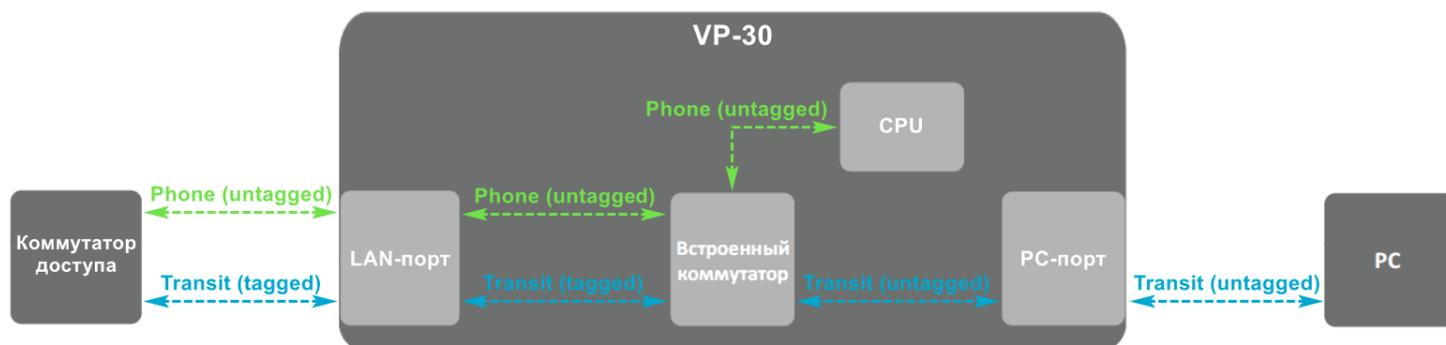
В данном случае сеть настроена по протоколу DHCP или Static с отключенным VLAN для Phone-трафика. Для транзитного трафика VLAN включен. Трафик, предназначенный для телефона, будет нетегированным. Транзитный трафик на входе и выходе LAN-порта будет тегированным, а на входе и выходе PC-порта – нетегированным.
