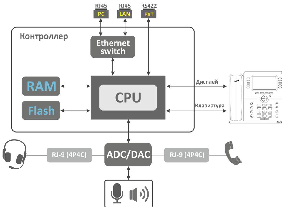
Устройство работает под управлением операционной системы Linux. Основные функции управления сосредоточены в процессоре.
