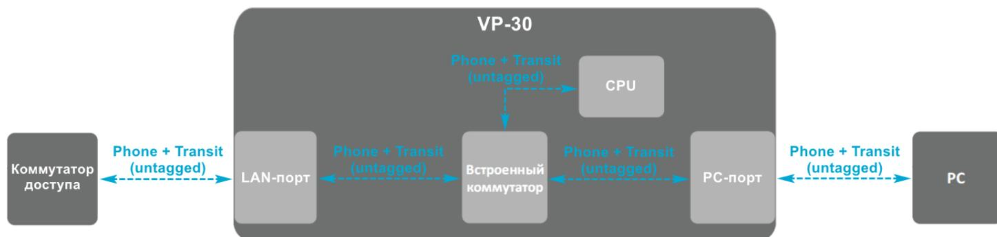
В данном случае сеть настроена по протоколу DHCP или Static с отключенными VLAN для Phone и транзитного трафика. Весь трафик (на схеме обозначен как «Phone + Transit»), проходящий через устройство, будет нетегированным.
