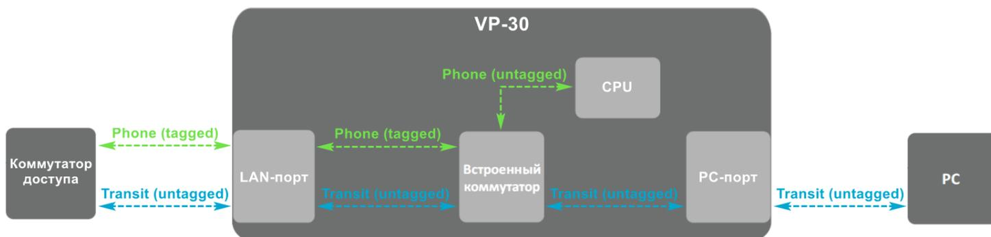
В данном случае сеть настроена по протоколу DHCP или Static с настроенным VLAN для Phone-трафика. Для транзитного трафика VLAN отключен. Трафик, предназначенный для телефона, будет тегированным. Транзитный трафик — нетегированным.
