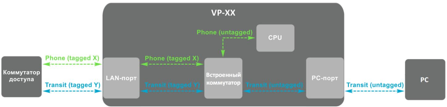
В данном случае сеть настроена по протоколу DHCP или Static с включенным VLAN для Phone и транзитного трафика с разными VLAN ID. Трафик, предназначенный для телефона, будет тегированным с одним VLAN ID. Транзитный трафик на входе и выходе LAN-порта будет тегированным с другим VLAN ID, а на входе и выходе PC-порта — нетегированным.
