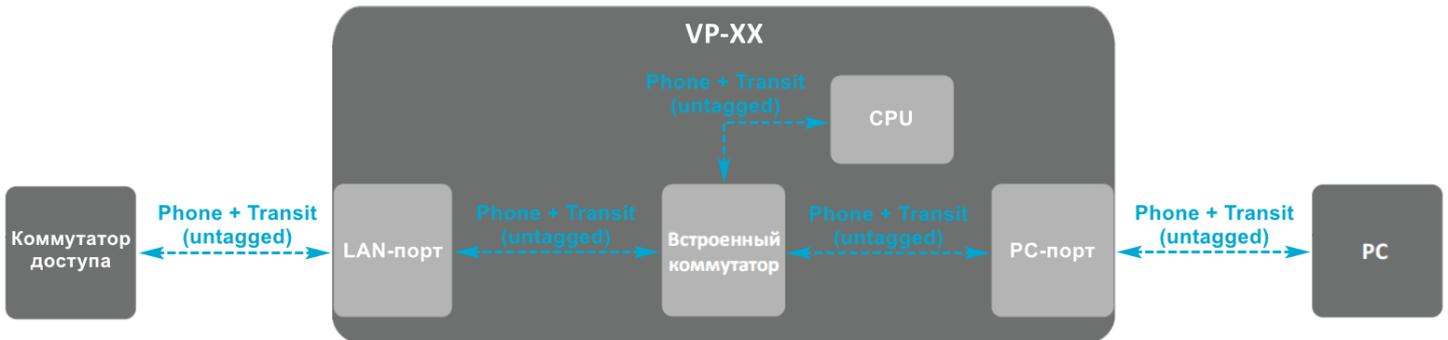
В данном случае сеть настроена по протоколу DHCP или Static с отключенными VLAN для Phone и транзитного трафика. Весь трафик (на схеме обозначен как «Data»), проходящий через устройство, будет нетегированным.
