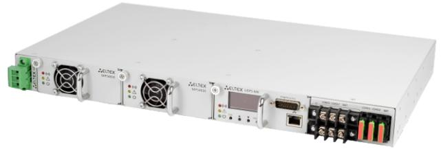
Устройство UEP5-2 предназначено для обеспечения электропитанием телекоммуникационного оборудования производства ЭЛТЕКС или других производителей с номинальным входным напряжением 48 В постоянного тока и мощностью до 3 кВт (60 А), а также для заряда свинцово-кислотной аккумуляторной батареи. UEP5-2 представляет собой модульную электропитающую установку, конструктивно выполненную в виде типового 19" каркаса высотой 1U.
