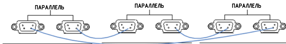
Рисунок 5-7. Схема параллельного подключения
