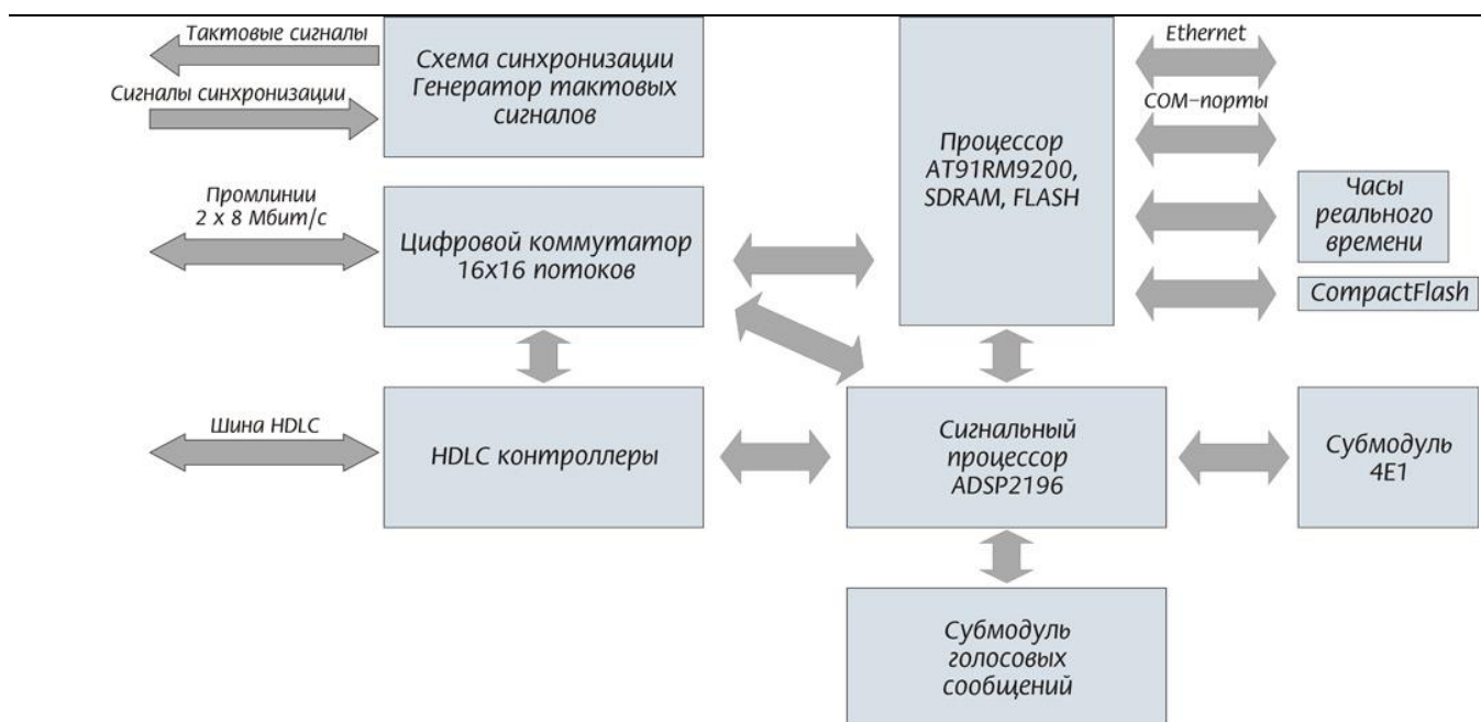
Рисунок 4 – Функциональная схема модуля ЦП
