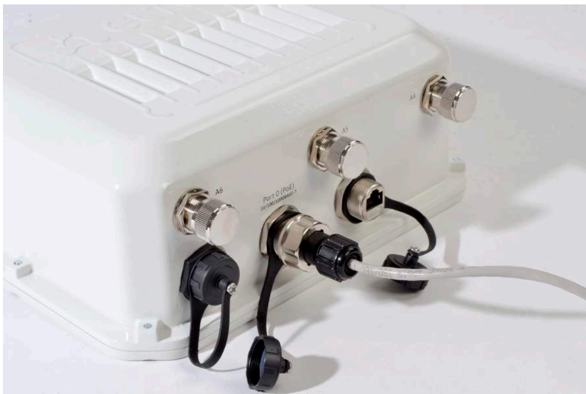
Рисунок 13 – Вид подключенного кабеля к сетевому интерфейсу устройства
