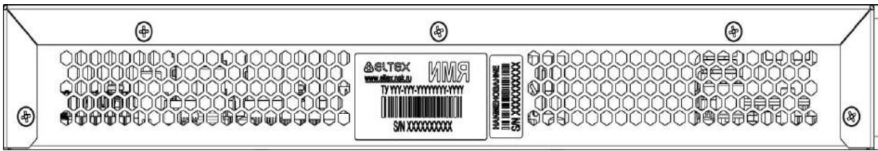
Рисунок 34 — Задняя панель MES2308, MES2308P, MES2308P DC, MES2308R
