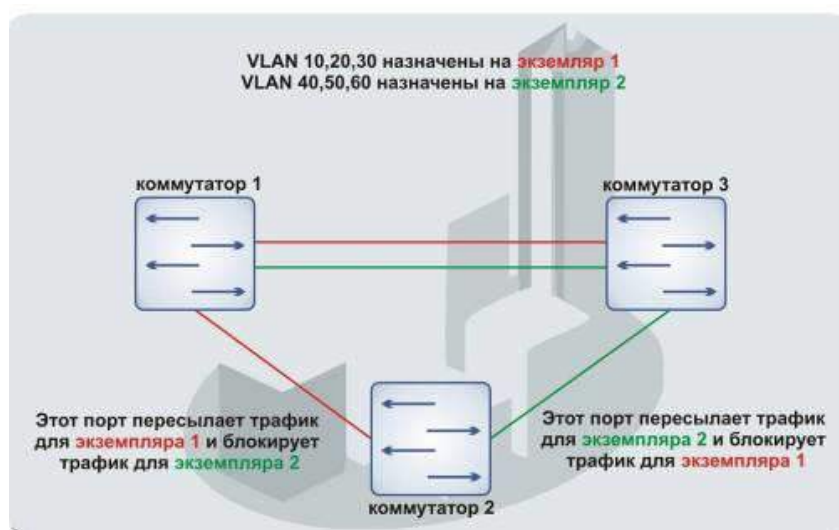
Рисунок А.1 – Настройка протокола множества связующих деревьев
