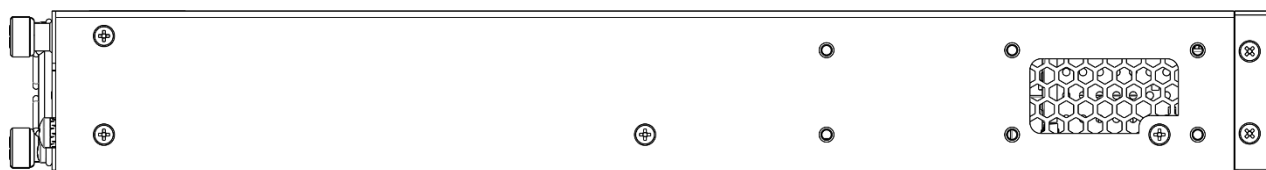
Рисунок 57 – Левая боковая панель MES3300-48
