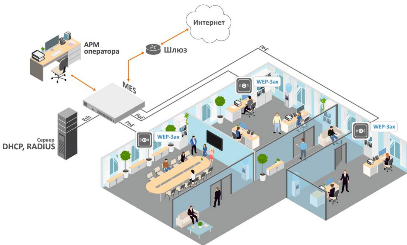
Рисунок 1 – Функциональная схема использования WEP-3ax, WEP-3ax-Z
