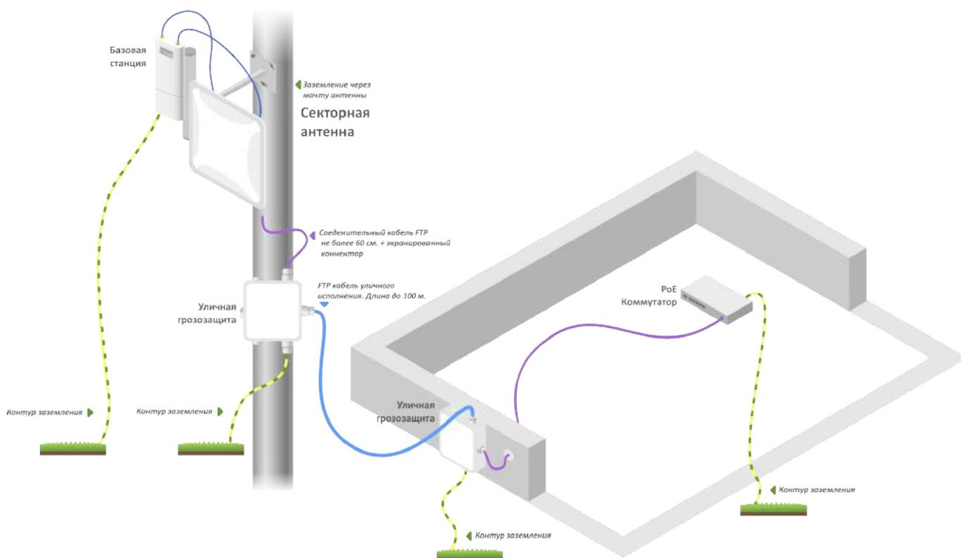
Рисунок 5 – Схема подключения базовой станции для обеспечения грозозащиты
