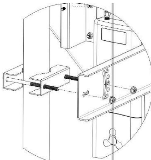
5. Снимите крышку, закрывающую Ethernet-порт на нижней панели устройства. Выполните заземление устройства через специальную клемму (для версии H/W: 1v5 и выше), затем подключите Ethernet-кабель к PoE-порту. При построении сети по оптоволокну установите трансивер и произведите подключение.
