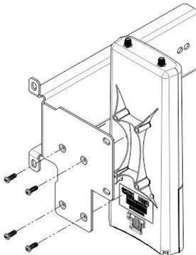
2. Зафиксируйте установочный кронштейн на антенне при помощи гаек.
