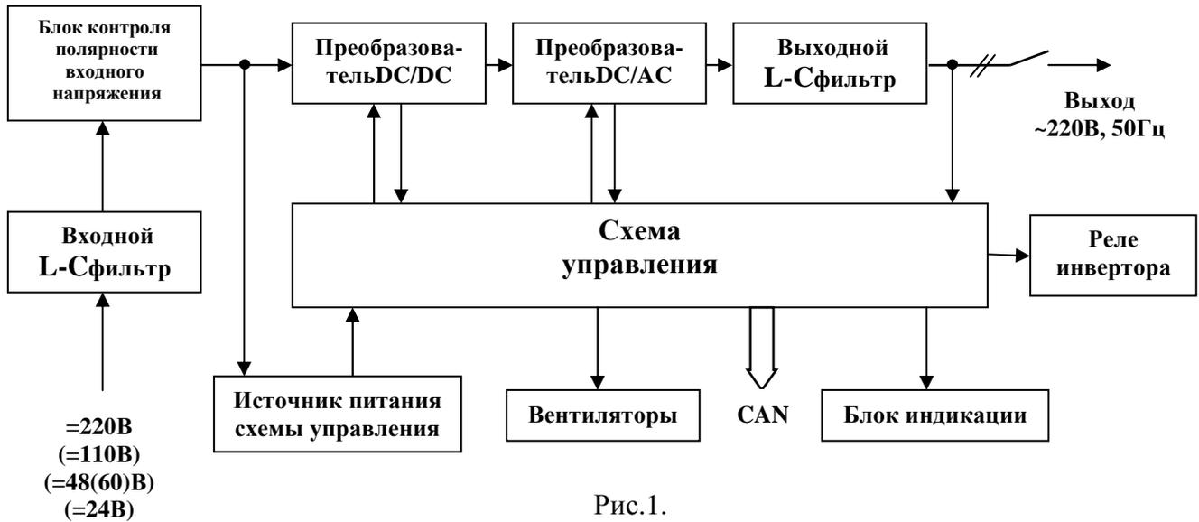
Входное постоянное напряжение через L-С фильтр, через блок контроля полярности, защищающий инвертор от неправильной полярности подключения по входу, поступает на вход преобразователя DC/DC и в источник питания схемы управления, формирующий стабилизированные напряжения питания активных элементов и обеспечивающий гальваническую развязку.
