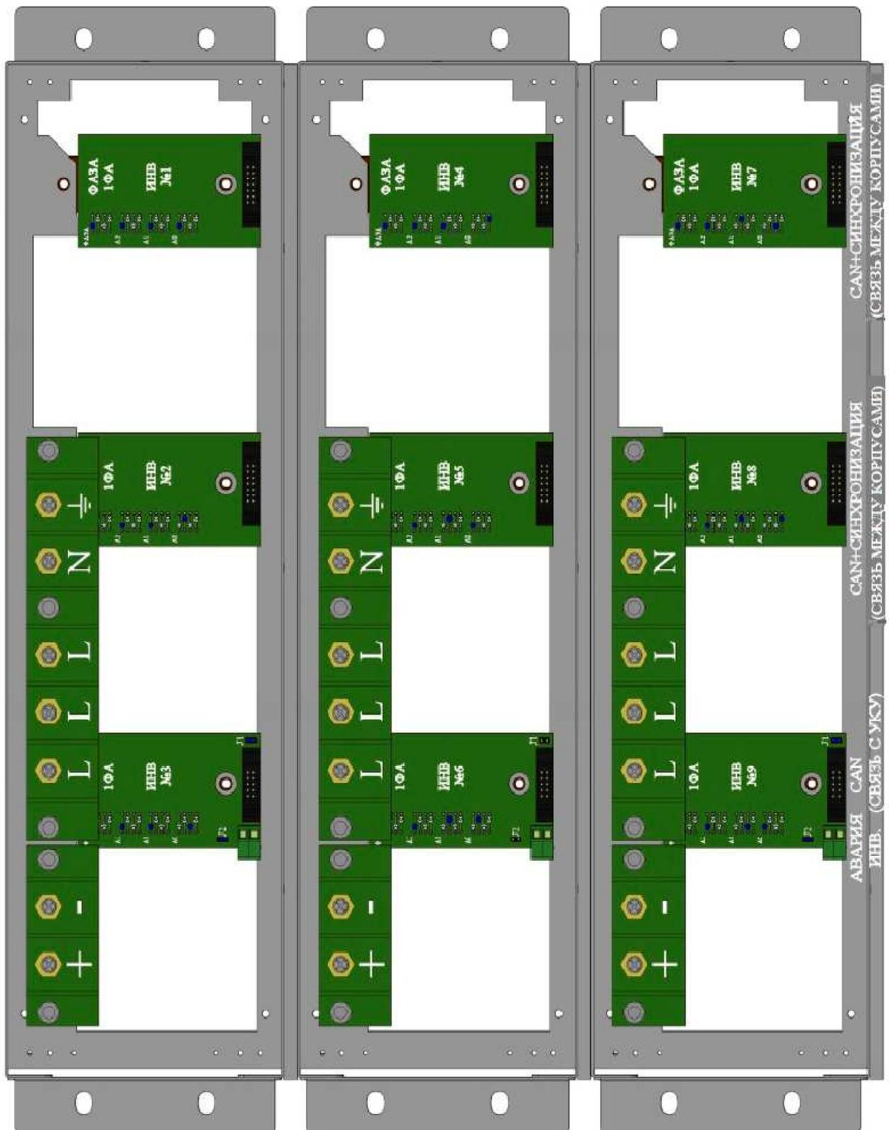
**ПРИЛОЖЕНИЕ 8. ПОДКЛЮЧЕНИЕ СИЛОВЫХ И СИГНАЛЬНЫХ КАБЕЛЕЙ НА ПРИМЕРЕ DC/AC-220/220(380)В-22500ВА(18000ВТ)-9У В ТРЕХФАЗНОМ РЕЖИМЕ РАБОТЫ**
