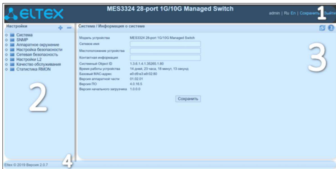
Рисунок 1 — Элементы навигации Web-конфигуратора
