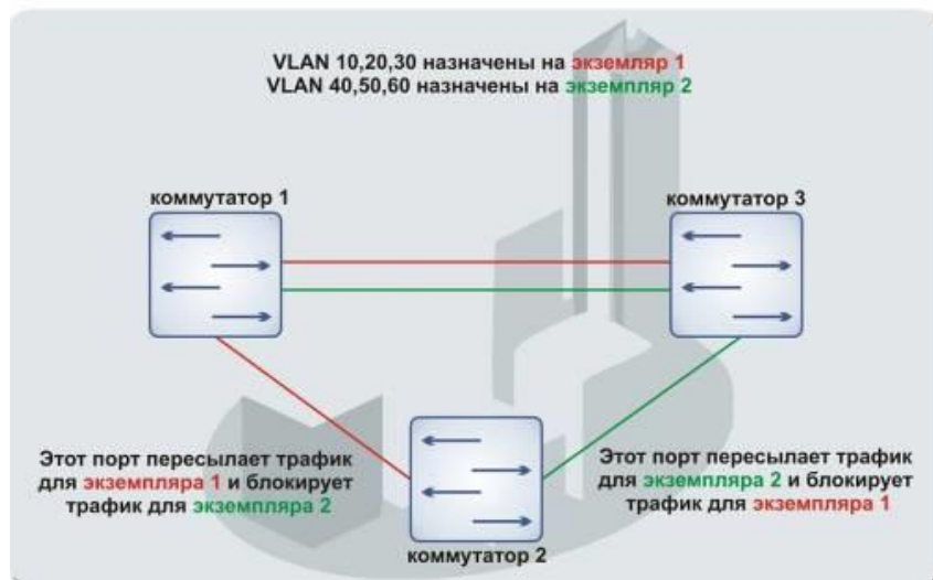
Рисунок А.1 — Настройка протокола множества связующих деревьев
