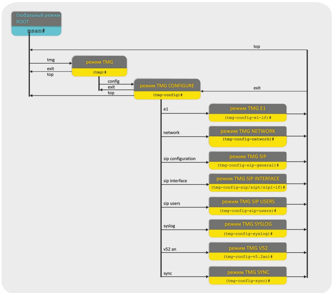
Рисунок 4 – Иерархия командных режимов для управления модулем цифрового VoIP-шлюза TMG-16
