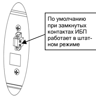
Рисунок 11 – Внешний вид порта дистанционного аварийного отключения (ЕРО), расположенного на задней панели ИБП
