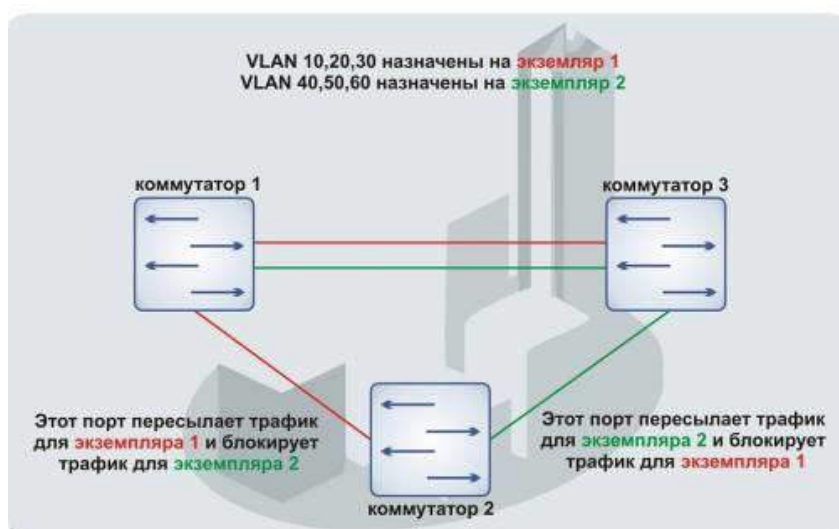
Рисунок А.1 — Настройка протокола множества связующих деревьев
