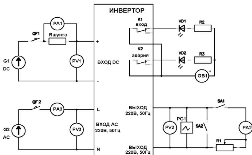
СХЕМА ПРОВЕРКИ ЭЛЕКТРИЧЕСКИХ ПАРАМЕТРОВ ИНВЕРТОРА
