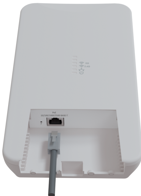
Рисунок 13 – Подключение Ethernet-кабеля к PoE-порту
