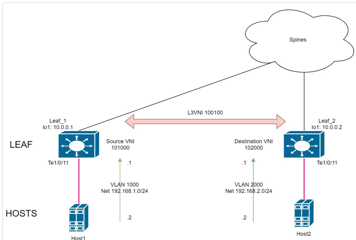
Anycast-gateway дополняет возможность различным Leaf выступать в роли шлюза для одной и той же сети. Хостам при переключении с одного Leaf на другой (например при миграции виртуальных машин) при использовании anycast-gateway нет необходимости обновления ARP-записи, т.к. MAC-адрес шлюза благодаря настройке не меняется от Leaf к Leaf. Подходит как для схем с multihomed подключением, так и для случаев, когда одна и та же сеть разбита на несколько физических сегментов, подключенных к разным Leaf.
