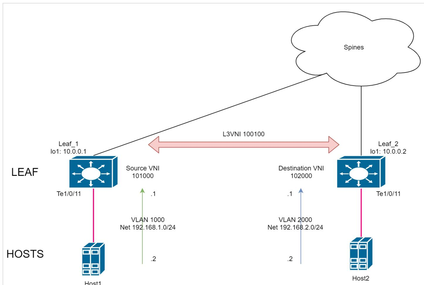
На устройстве Leaf\_1 создадим VXLAN с VNI 101000 и VLAN 1000. Необходимо добавить IP-интерфейс VLAN 1000 в VRF1, чтобы для маршрутизации пакетов клиента использовалась L3VNI. Затем назначить на этот IP-интерфейс IP-адрес.
